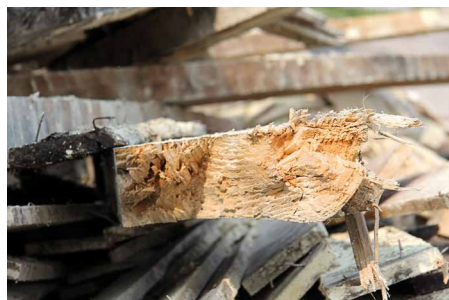
Abb. 6 u. 7: kurzfasrige Bruchstellen, links während des Rückbaus entstandener frischer Bruch, rechts alter Bruch (substratgeschwärzt)
